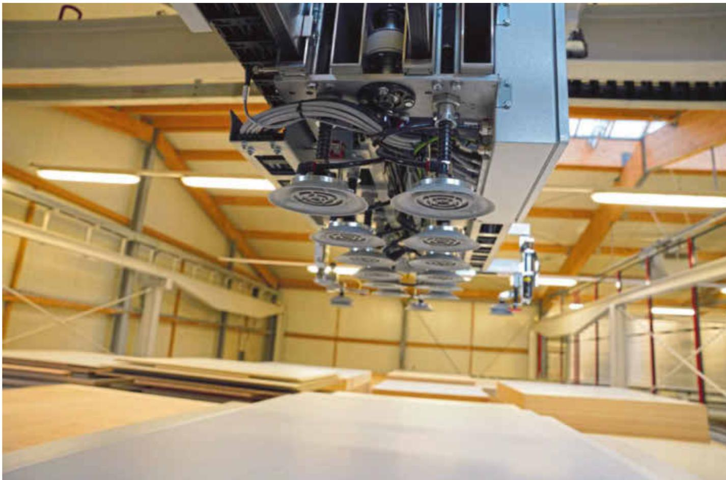
*Das neue Flächenlager in zweiter Ebene leistet bei Raumin den entscheidenden Beitrag, die neue Aufteilsäge fh 4 besser auszulasten, und spart gleichzeitig den im Fürstentum Liechtenstein knappen und teuren Lagerplatz.*
