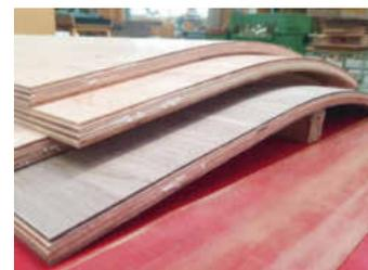
/ Atmos zeigt u. a. die prozesssichere Formverleimung in der Vakuumpresse.
