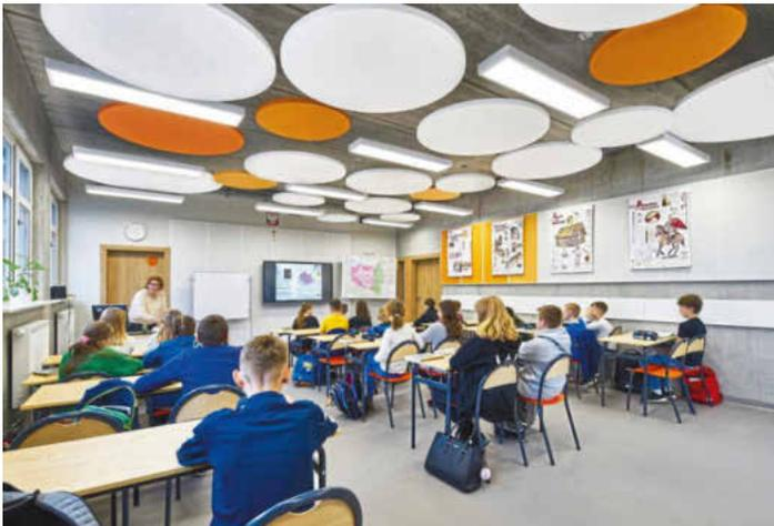
/ Bessere Akustik im Klassenzimmer: Deckensegel mit schallabsorbierender Wirkung sind in unterschiedlichen geometrischen Formen und Farbvarianten erhältlich.
