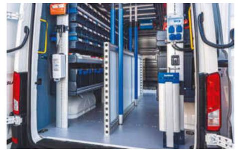
*Die Teleskop-Spannstrangen passen sich dank der exzentrischen Form dem Transportgut optimal an.*
