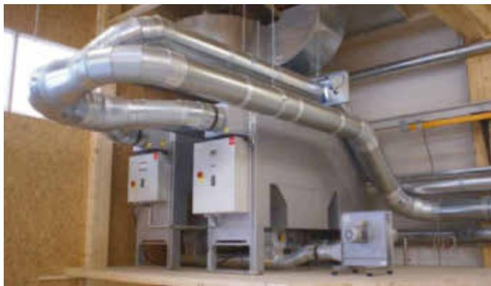
*/ Es werden zwei Stationen mit je zwei Entstaubern auf dem Messestand aufgestellt und betrieben. Jeder Entstauber hat eine maximale Luftleistung von 10 000 m³/h.*
