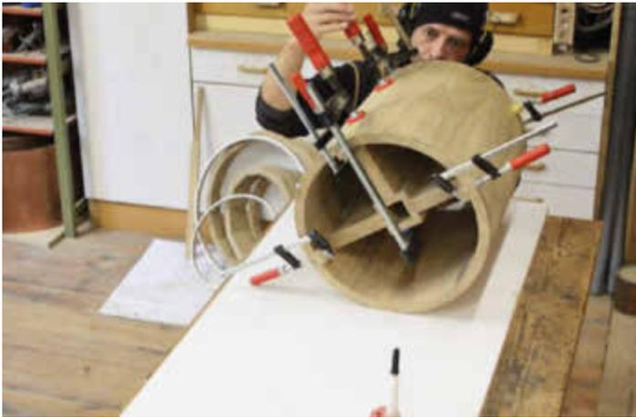
*/ Der runde Innenkorpus erhält die T-förmige Konstruktion, die an ihren drei Enden die Holzvollauszüge und im Inneren den Linearantrieb für den Schublift aufnimmt.*
