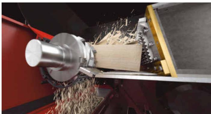
/ Mit Zerkleinerungsmaschinen und Brikettierpressen können Holzreststoffe zur energetischen Nutzung weiterverarbeitet werden.
