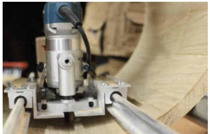
*/ Dieselbe Vorrichtung dient auch zum exakten Rundfräsen der Innenkontur – der außen runde Zylinder ist dabei auf zwei drehbaren Wellen beweglich gelagert.*
