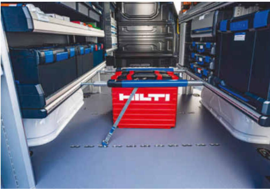
*Das integrierte Prosafe-System erlaubt neben der vertikalen auch eine horizontale Befestigung der Spannstrangen im Laderaum des Fahrzeugs.*
