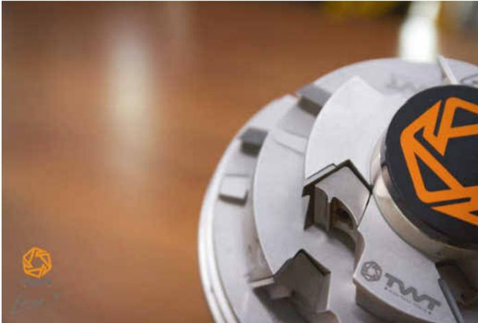
Im Haltekeil der Messer des Werkzeugsystems Laser S führt ein Spanauswurf-abweiser die Späne unmittelbar vom Werkzeugkörper der Absaugung zu.
