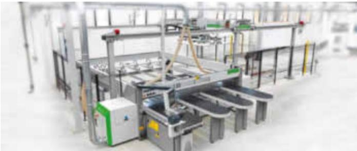
/ Effizienter Zuschnitt: In die Lagerlösung Winstore integrierte Selco-Plattensäge.
