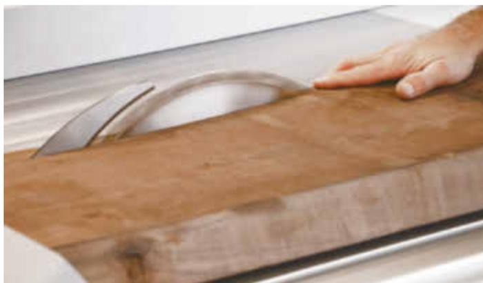
/ Bei Erkennung unerwarteter, schneller Annäherungen im Sägeblattbereich löst das Preventive Contact System (PCS) die Sicherheitsabsenkung aus.
