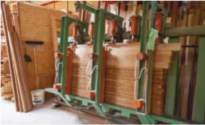
*/ An der Hydraulikpresse werden bis zu 6 m lange Kanteln gepresst. Leimzeiten müssen genau eingehalten werden, damit sie die strengen Leimtests bestehen.*
