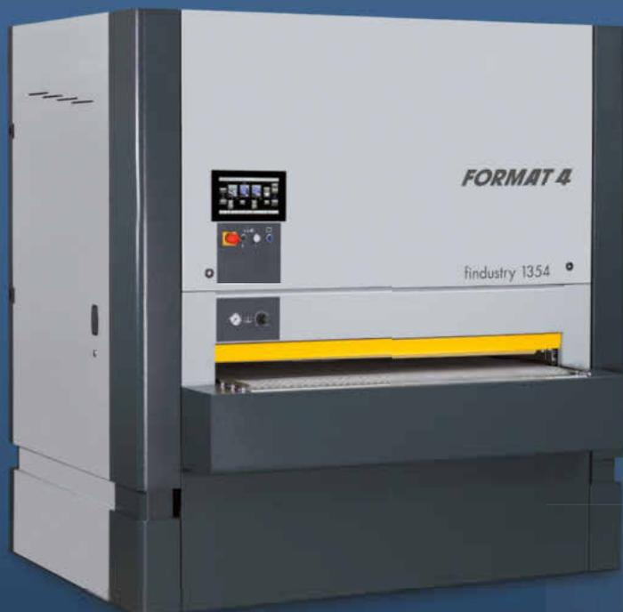
Die Format4 Breitbandschleifmaschinen **findustry** überzeugen im Möbelbau, in der Massivholz- und Treppenbearbeitung. Dank unterschiedlich kombinierbarer Schleifaggregate ist ein extrem hoher Individualisierungsgrad zur Erfüllung aller Anforderungen hinsichtlich Oberflächenergebnis und Bearbeitungseffizienz garantiert.
