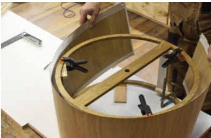
*/ Lichtdurchlässig: Der nach oben und unten offene Lampenschirm wird mit selbst hergestelltem, vlieskaschiertem, nur 1 mm starkem Furnier umhüllt.*
