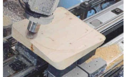
/ Mit der Anbindung an den Postprozessor generieren Pytha und Staircon die CNC-Programme automatisch.
