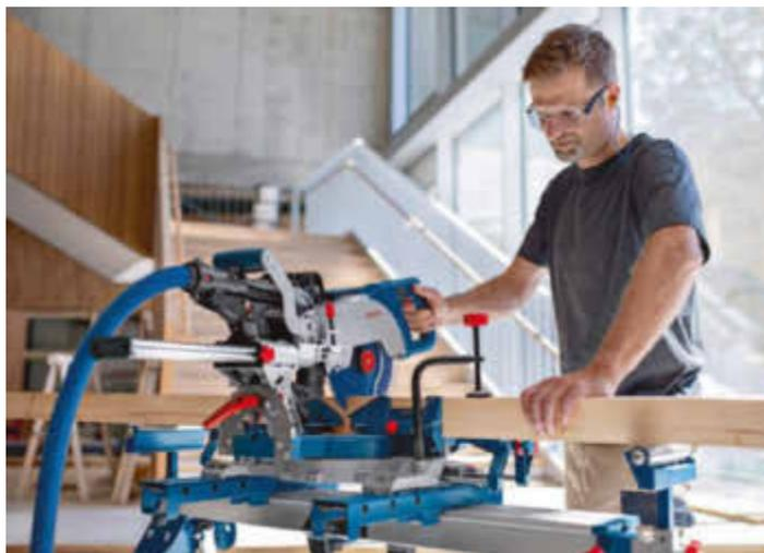
/ Die mobile Biturbo-Kapp- und Gehrungssäge GCM 18V-216 DC Professional bietet hohe Präzision, Flexibilität und ein breites Anwendungsspektrum.
